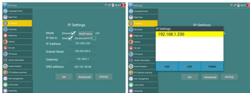
После установки расширенного IP-адреса (см. Фотографии выше) устройство может протестировать два сетевых сегмента (192.168.5.0) и (192.168.1.0).
