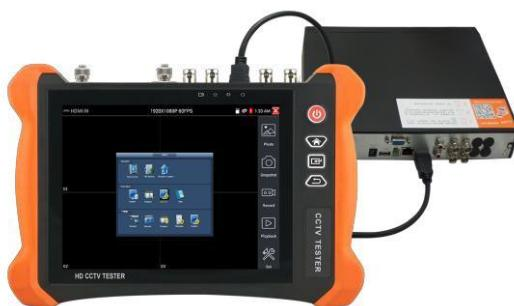
Выходной порт HDMI DVR или другого устройства подключается к входному порту HDMI тестера, измеритель отобразит входное изображение.
