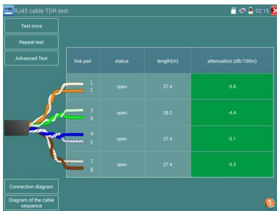
**Протестируйте один раз:** Проверьте состояние кабеля, длину и затухание.
