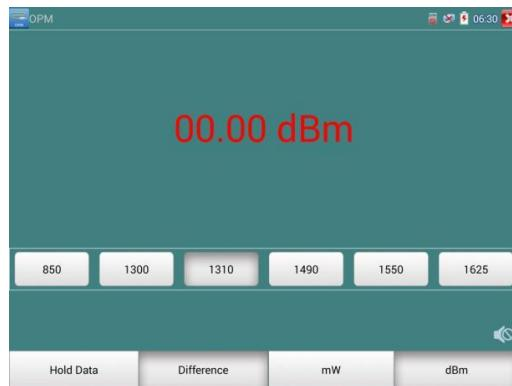
Удержание данных и относительное измерение используются вместе, данные желтые, пока функция действует.
