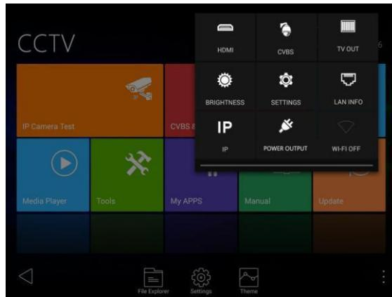
**HDMI:** Нажмите HDMI IN для входа в режим HDMI IN, он может преобразовать тест из аналогового в цифровой с двойным тестовым окном IP и HDMI IN или аналоговый и HDMI in
